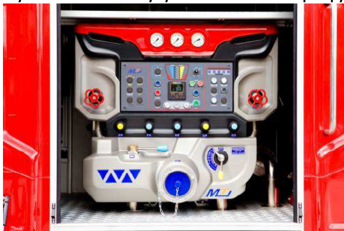
Rysunek 1 Elektroniczny system sterowania autopompy
